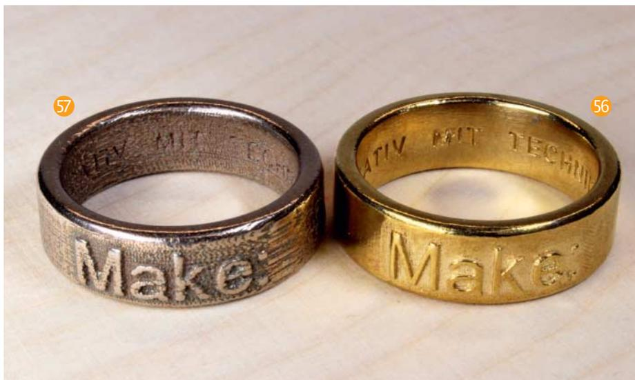
stellen. Wir haben den Ring testweise auf einen Ultimaker 2+ mit einer Düse von 0,4mm Bohrung und einer Schichtdicke von 0,1mm ausgedruckt. Die Auflösung der äußeren Schrift ist gut und die innere Schrift gut lesbar (54).
