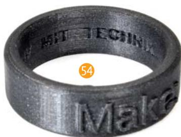
dem eher einem Vieleck gleicht. Das Dateiformat STL besteht nur aus Punkten, Kanten und Flächen dazwischen (kurz Mesh genannt), deshalb werden runde Körper durch Vielecke ersetzt. Bestehen die aus zu wenigen Punkten, entstehen störende Kanten.
